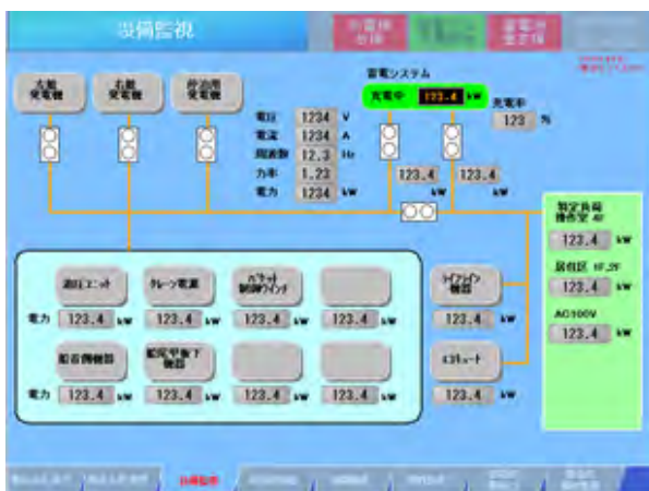
図-6 「見える化」モニター（設備監視）
