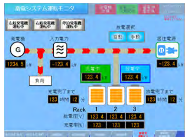
図-2 蓄電システム運転モニター
